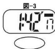
ストップウォッチの最大計測時間は99:59'59です。最大計測時間を過ぎるとディスプレイは 00'00.00に戻り計測を続けます。
